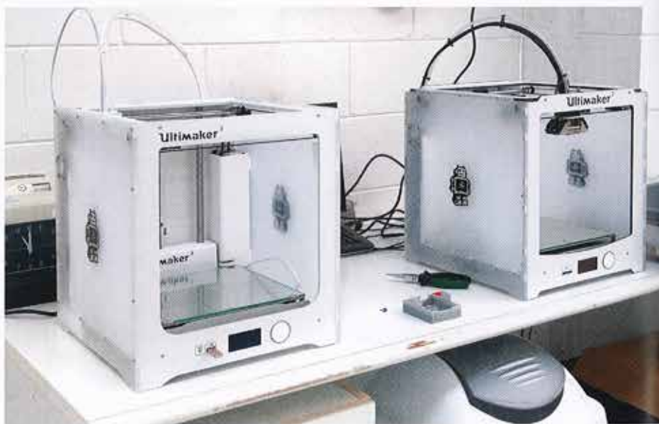
Due Ultimaker, stampanti 3D di polimeri con tecnologia FDM, ancora operative in Aidro: hanno aperto la strada alla stampa 3D industriale di metalli.
