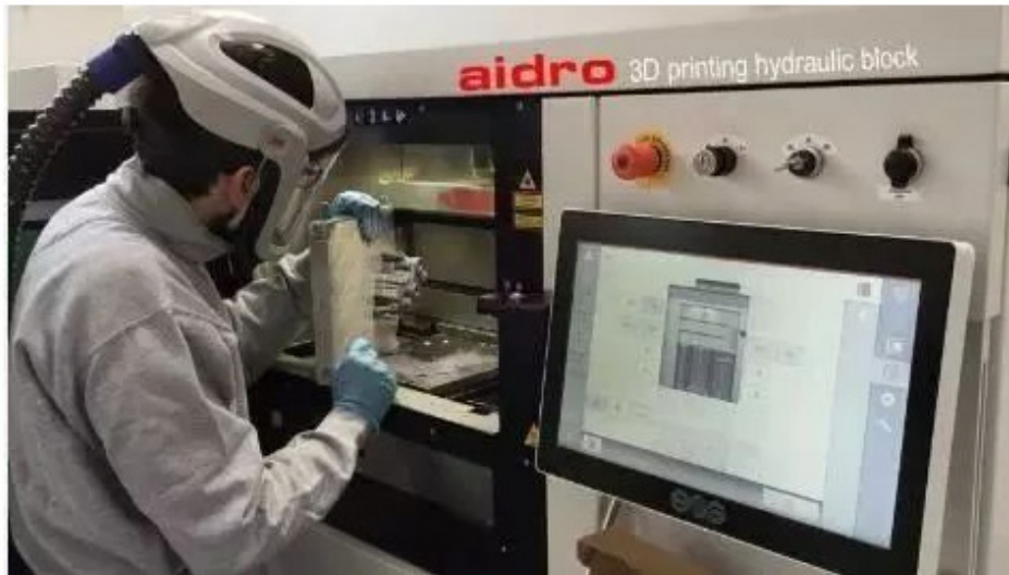
aidro hydraulics 为农业机械客户制造的3D打印液压阀块，打印设备为EOS M 290
